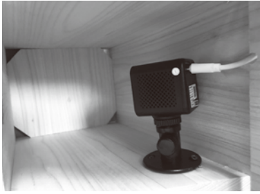
写真2 セキュリティカメラの設置例
