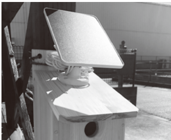
写真3 ソーラーパネルの設置例
